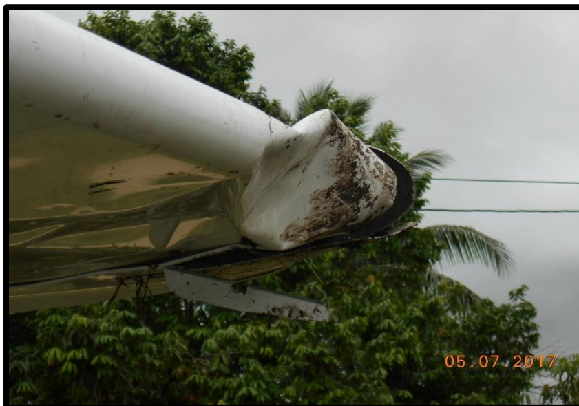
Fotografía No. 7 Vista de la punta del ala izquierda golpeada.
